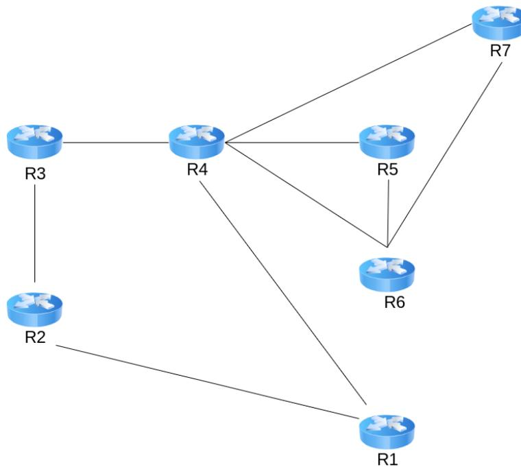
On donne les tables de routage préalablement construites ci-dessous avec le protocole RIP (Routing Information Protocole). Le protocole RIP permet de construire les tables de routage des différents routeur en indiquant pour chaque routeur, la distance, en nombre de sauts, qui le sépare d'un autre routeur.
